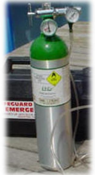
Para sua utilização deve possuir registro (abre e fecha o oxigênio), um regulador (existem diferente tipos no mercado) que reduza a pressão do cilindro a pressões seguras para uso permitindo regular a quantidade de O2 a ser administrado (1 a 25 litros/min).
